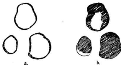
Abb. I. Schematische Darstellung der Färbung der Harzkörnchen (Cr=2 \gamma /0.02 ccm als K_2Cr_2O_7 ) a. = Amberlite IRA-400. b. = Amberlite IRA-411.
